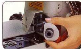
專利設計全新改良，可調換之底線供給機構不易絞線。
